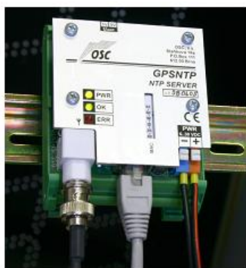
Obrázek 7-2: GPSNTP server Stratum 1 řízený GPS
